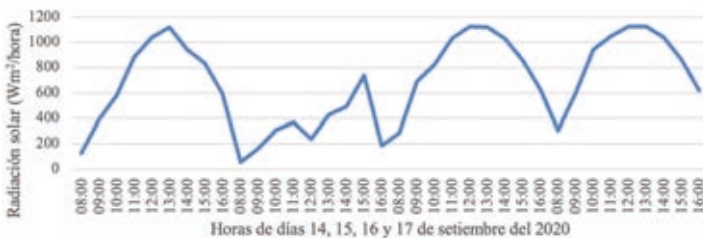
Figura 2 Curva de radiación solar de los días 14, 15, 16 y 17 de septiembre del 2020.
