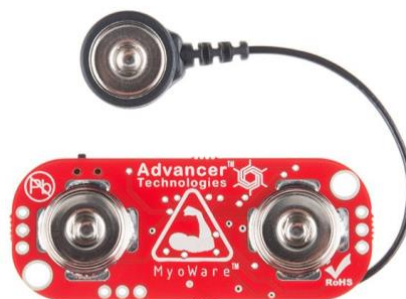
Fig. 2. Características del sensor MyoWare.
