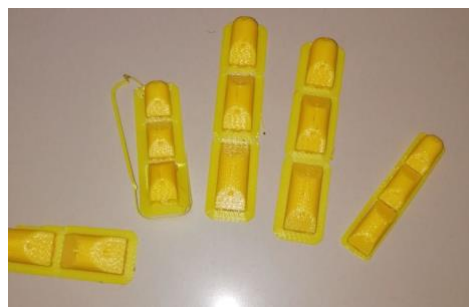
Fig. 10. piezas impresas, en representación a los dedos de la mano. Fuente: elaboración propia
