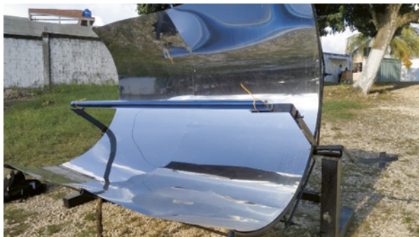
Figura 5. Colector solar cilíndrico parabólico terminado
