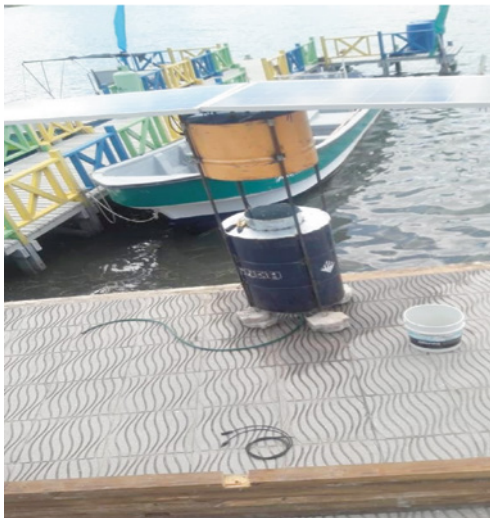
Figura 2. Acondicionamiento y conexiones del prototipo de caneca acuática para la recolección de basura en la reserva Seaflower.
