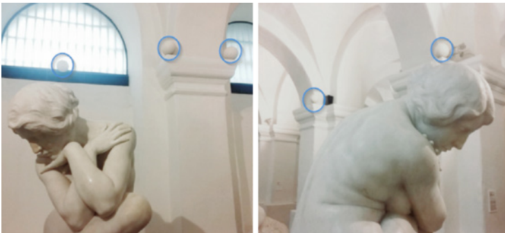
Figura 2 Distribución de esferas para empalmar el levantamiento.
