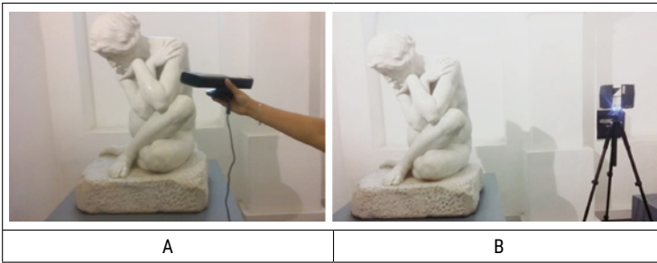
Figura 1 Escaneo de la escultura con sensor Kinect y con Laser scanner FARO FOCUS 3D
